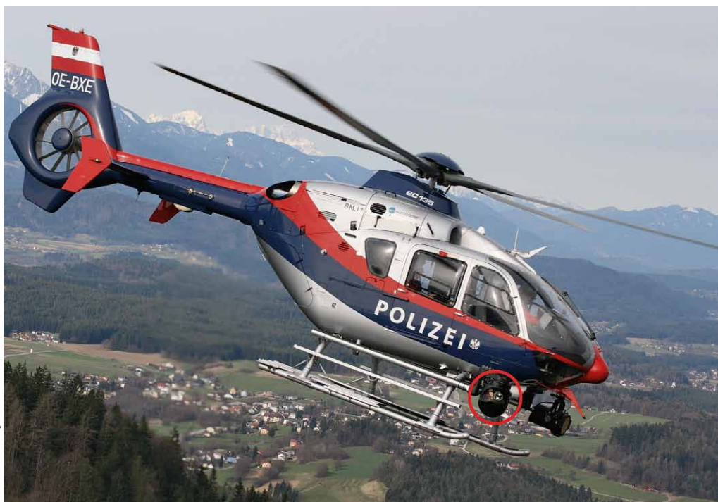
Die Kamera ist an der rechten Seite des Hubschraubers angebracht
